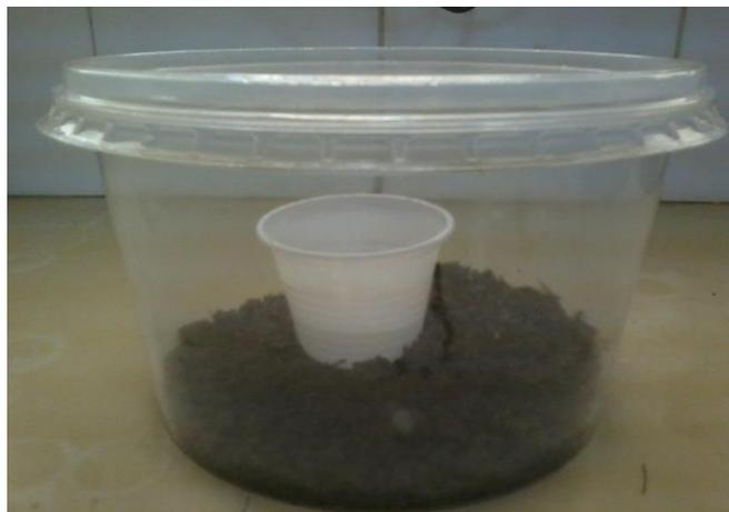
**Figura 1** – Unidade experimental para medição da atividade microbiana.
