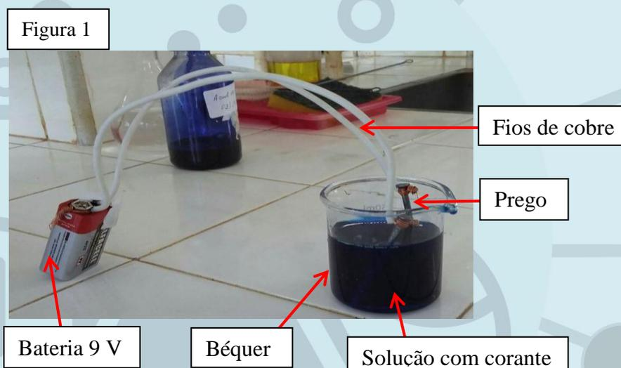
3. Os pregos serão, a seguir, conectados a uma fonte de corrente contínua (DC, uma bateria de 9 V ou 3 pilhas em série), por meios de fios de cobre comuns utilizando garras do tipo “jacaré”. Os pregos não devem ser tocados para impedir a ocorrência de um curto-circuito. A partir desse momento, o anodo da célula começa a ser lentamente dissolvido por oxidação, enquanto é possível observar bolhas de hidrogênio sendo produzidas sobre o catodo.
