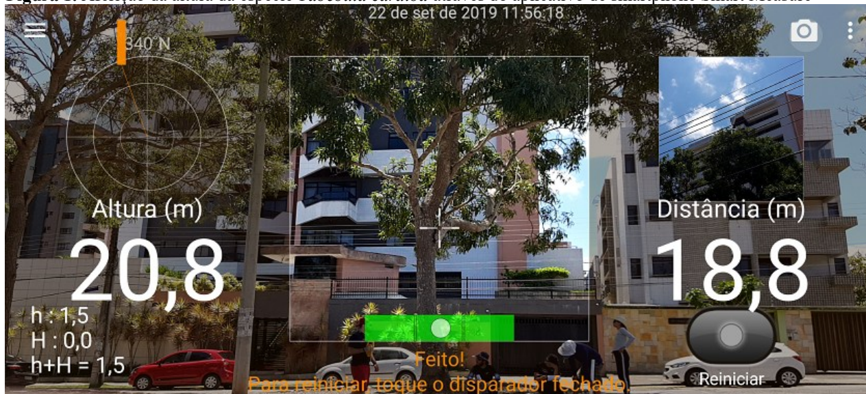
Figura 1. Aferição da altura da espécie Tabebuia caraiba através do aplicativo de smartphone Smart Measure
