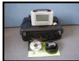
Figura 3 – Ecobatímetro Ohmex.
