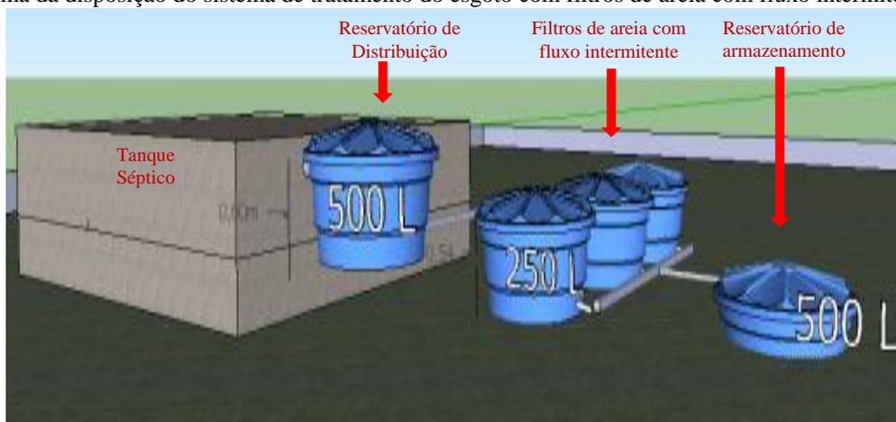
Os filtros foram construídos adaptando recipientes plásticos com capacidade de 250 L cada; na parte inferior dos recipientes continha uma camada de 10cm com brita (nº 1),
